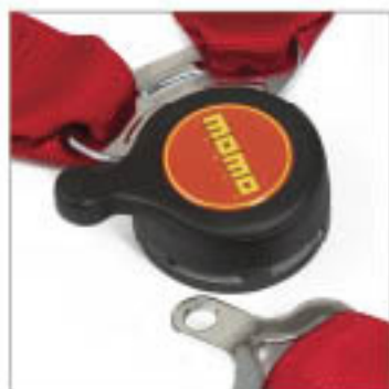
Particolare dello sgancio rapido aeronautico - Aircraft Quick release Close up
